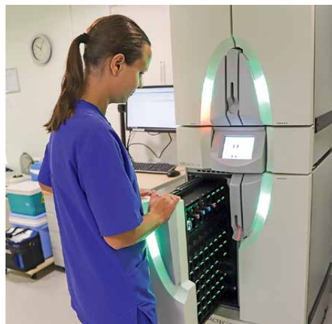
Uus vere külvialüsaator vereteenistuses detekteerib mikroobide kasvu, mille edastamiseks kasutatakse heli- ja värvisignaale.
